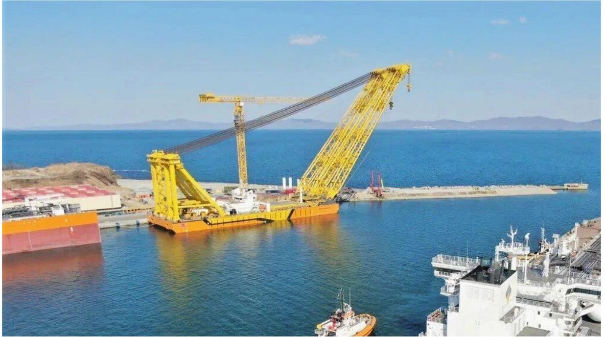
Рисунок 7 – Плавучий кран 3500 РС
